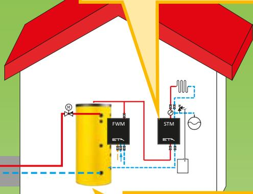
Preparazione economica, igienica e rapida dell'acqua calda sanitaria: con l'accumulatore **ETA ECO** ed il **modulo acqua calda sanitaria ETA**.
