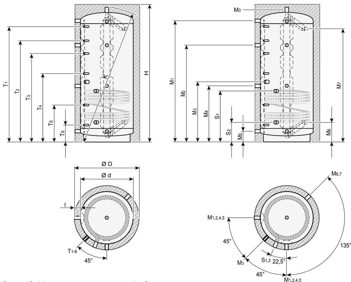
Il raccordo  $M_3$  senza compensatore termico è predisposto per il raccordo di ritorno delle caldaie che devono riscaldare solo la metà superiore del puffer o per una cartuccia di riscaldamento elettrica con collegamento a vite con filettatura esterna 6/4".
