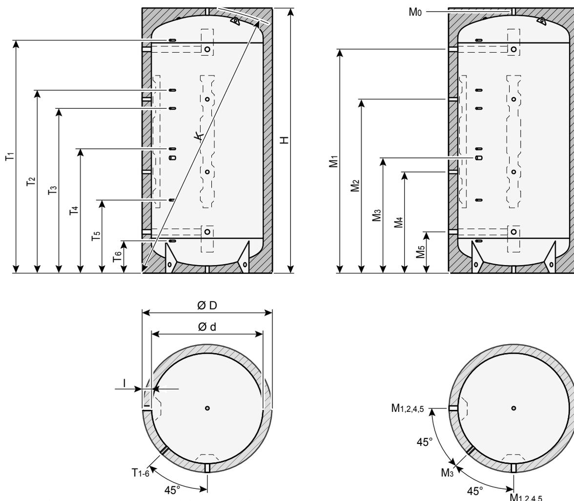
I raccordi M1 e M5 sono provvisti di speciali cilindri di entrata/uscita e sono dunque destinati a potenze caldaia maggiori, fino a 500 kW (25 m<sup>3</sup>/h).
