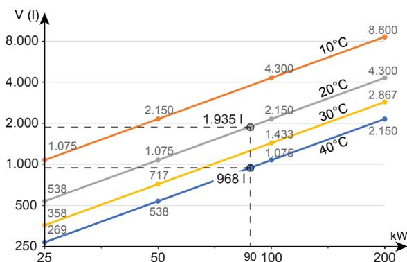
**Attenzione:** per richiedere sovvenzioni, in Germania per le caldaie a caricamento automatico sono necessari almeno 30 litri di volume del puffer per ogni chilowatt di potenza della caldaia.
